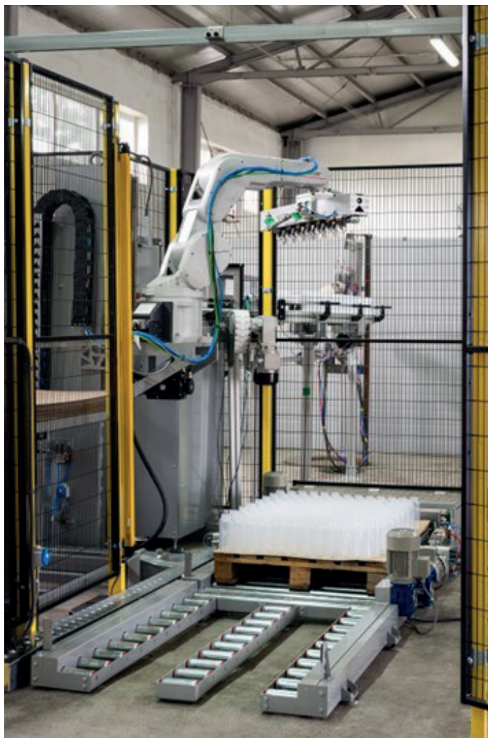
Rys. 19. Robot przemysłowy - paletyzer w ograniczonej przestrzeni produkcyjnej
